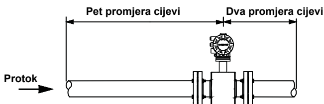
Slika 4. Promjeri cijevi ispred i iza mjernog pretvornika
