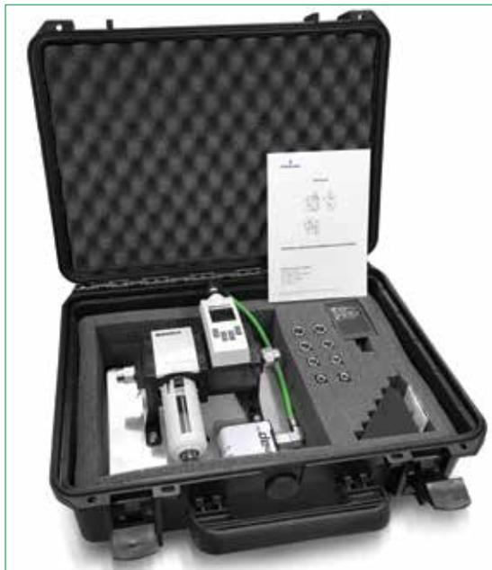
Lo Smart Pneumatics Analyzer (SPA) di Aventics consente ai clienti di accedere facilmente ai dati in tempo reale per monitorare i parametri del sistema pneumatico e migliorare l'efficienza complessiva delle apparecchiature (OEE)
