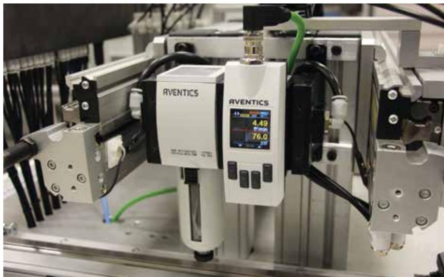
Il sensore Aventics AF2 fornisce informazioni in tempo reale sul flusso d'aria, rilevando anche i dati di pressione e temperatura nella linea di alimentazione
