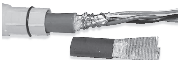
Figure 3-5 : Fils de blindage enroulés deux fois autour du feuillard
