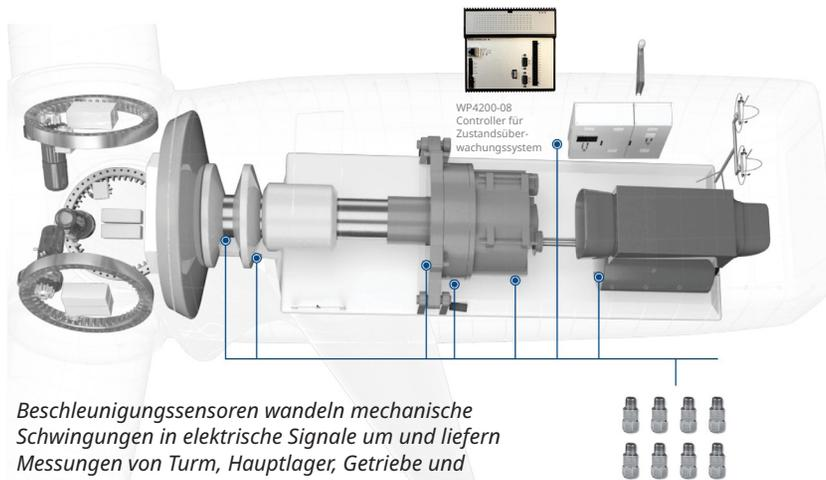
*Beschleunigungssensoren wandeln mechanische Schwingungen in elektrische Signale um und liefern Messungen von Turm, Hauptlager, Getriebe und Generator an das Zustandsüberwachungssystem, das die Schwingungssignale in Echtzeit verarbeitet.*
