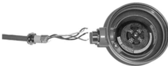
7. Inserte los hilos a través del cuerpo del prensaestopas y ensamble el prensaestopas apretando la tuerca correspondiente a éste.
