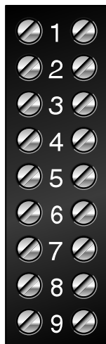
Figura 5-8: Terminali per tutti i sensori D e DL, e serie F precedenti al 2005
