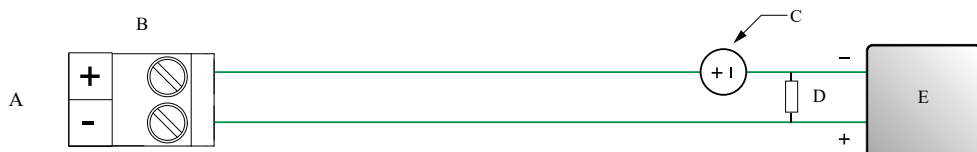
Figura 4-9: Cableado DO de energía externa
