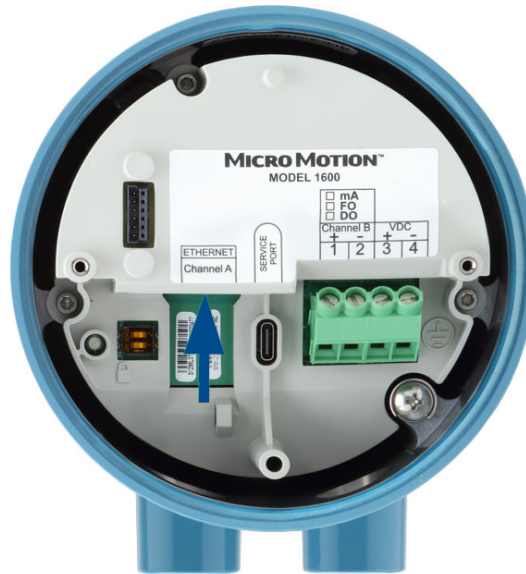
Figura 5-2: Conexión de PoE en el canal A del transmisor
