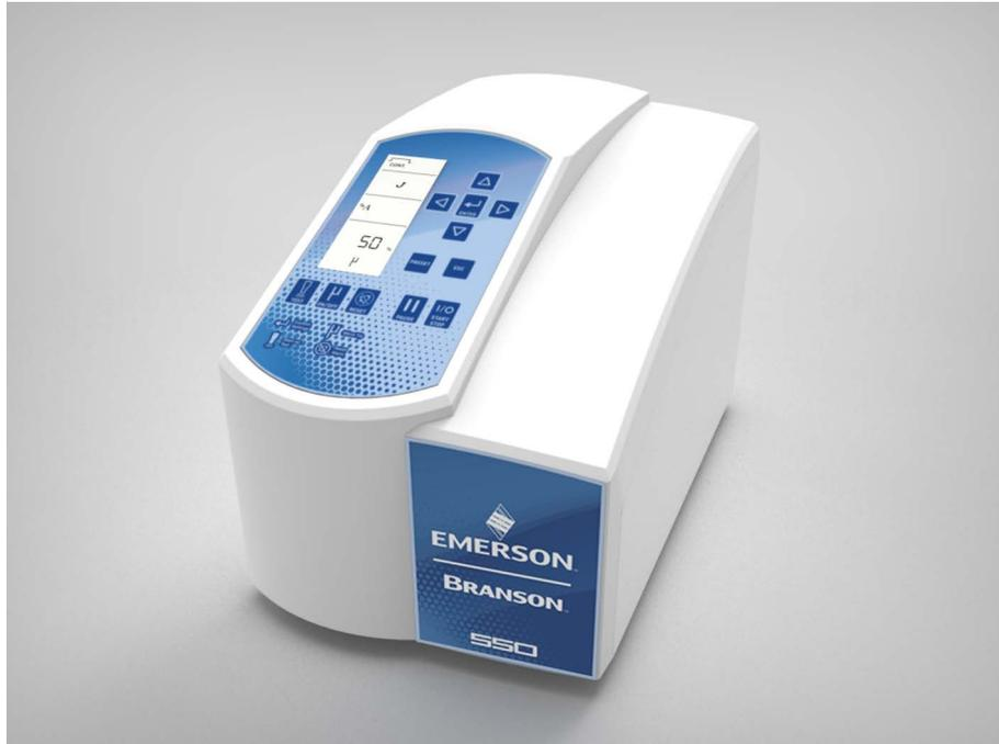
Sonifier 파워 서플라이는 AC 선간 전압을 20kHz 또는 40kHz 전기 에너지로 변환합니다. 이 고주파수 전기 에너지는 기계 진동으로 변환되는 컨버터에 공급됩니다. 컨버터의 심장부는 전기변형 요소로서 교류 전압이 적용되면 확장하고 수축합니다. 컨버터는 세로 방향으로 진동하고 용액에 담겨져 있는 혼 팁으로 움직임을 전달하므로, 공동화를 유발합니다.
