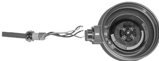
6. Schieben Sie die Adern durch den Doppelnippel der Verschraubung und ziehen die Überwurfmutter an.
