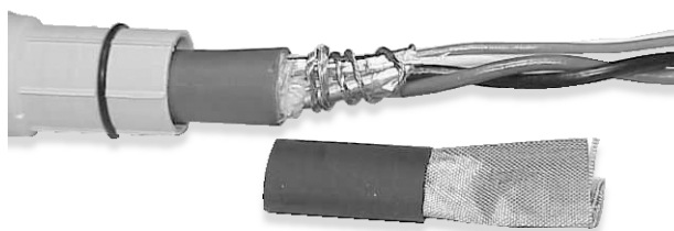
Rysunek. 3-5: Przewody uziemienia owinąć dwukrotnie wokół odsłoniętej folii
