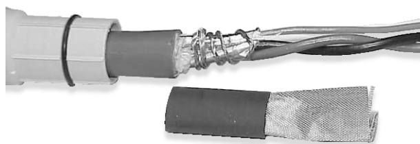
Figur 3-5: Skjermledningene viklet to ganger rundt den eksponerte folieskjermen
