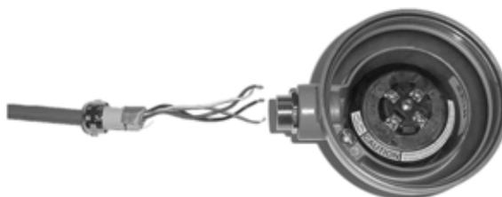
7. ワイヤをグランド本体を通して挿入し、グランドのナットを締め付けてグランドを組み立てます。
