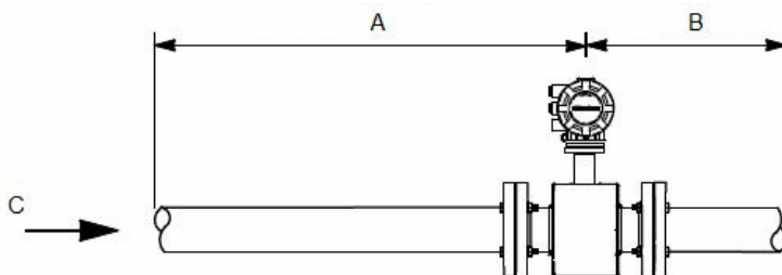
Figura 1: Diâmetros do tubo reto upstream e downstream
