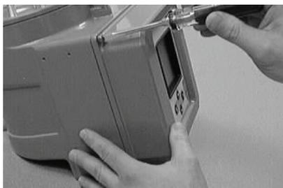
1. Utilice un destornillador plano para aflojar los tornillos cautivos que fijan la cubierta del indicador al alojamiento.
