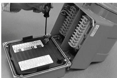
2. Utilice un destornillador plano para aflojar los tornillos cautivos que fijan la cubierta posterior a la cubierta del indicador. Tome nota de cuál tornillo sujeta el hilo de tierra a la cubierta posterior.
