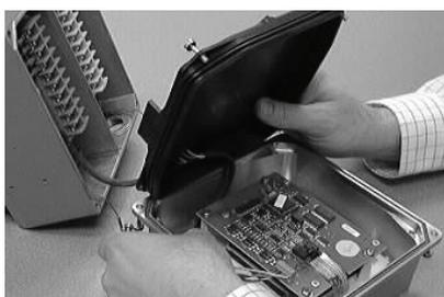
5. Sin tocar la tarjeta de circuito, acomode el cableado de manera que no quede atrapado con la tarjeta de circuito y la cubierta posterior, luego vuelva a colocar la cubierta posterior.
