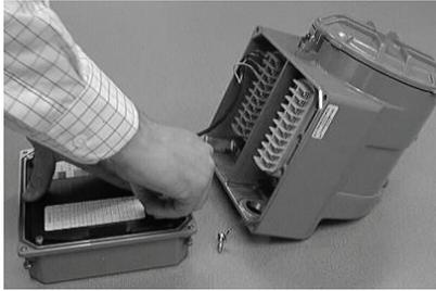
6. Tire de la válvula de alivio de presión mientras presiona la cubierta posterior en su lugar. Asegúrese de sujetar el hilo de tierra a la cubierta posterior utilizando el tornillo correcto. Si sujeta el hilo de tierra al tornillo incorrecto, el hilo de tierra puede quedar atrapado.
