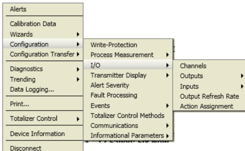
**Figura C-10: Configuración: Pantalla del transmisor**
