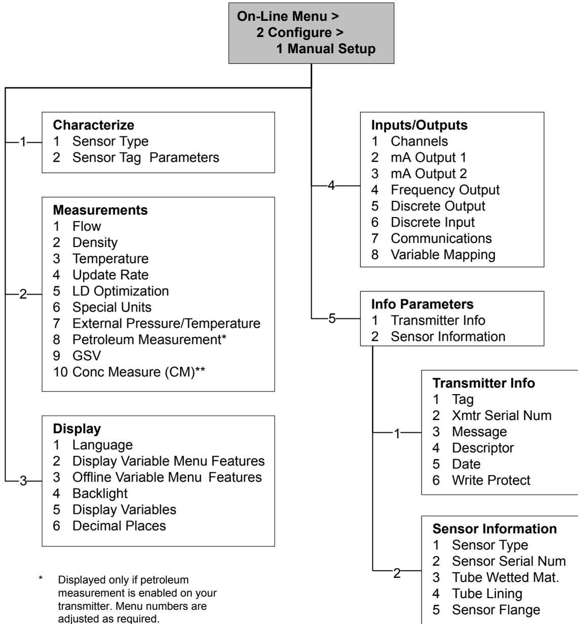
Figura D-8: Menú Configuración manual: Caracterizar
