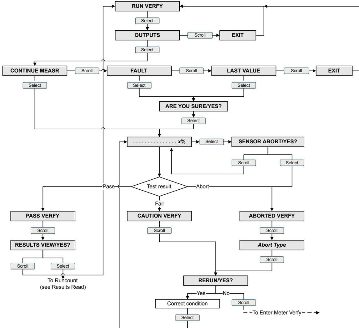
Figura A-11: Menú fuera de línea: resultados de verificación del medidor
