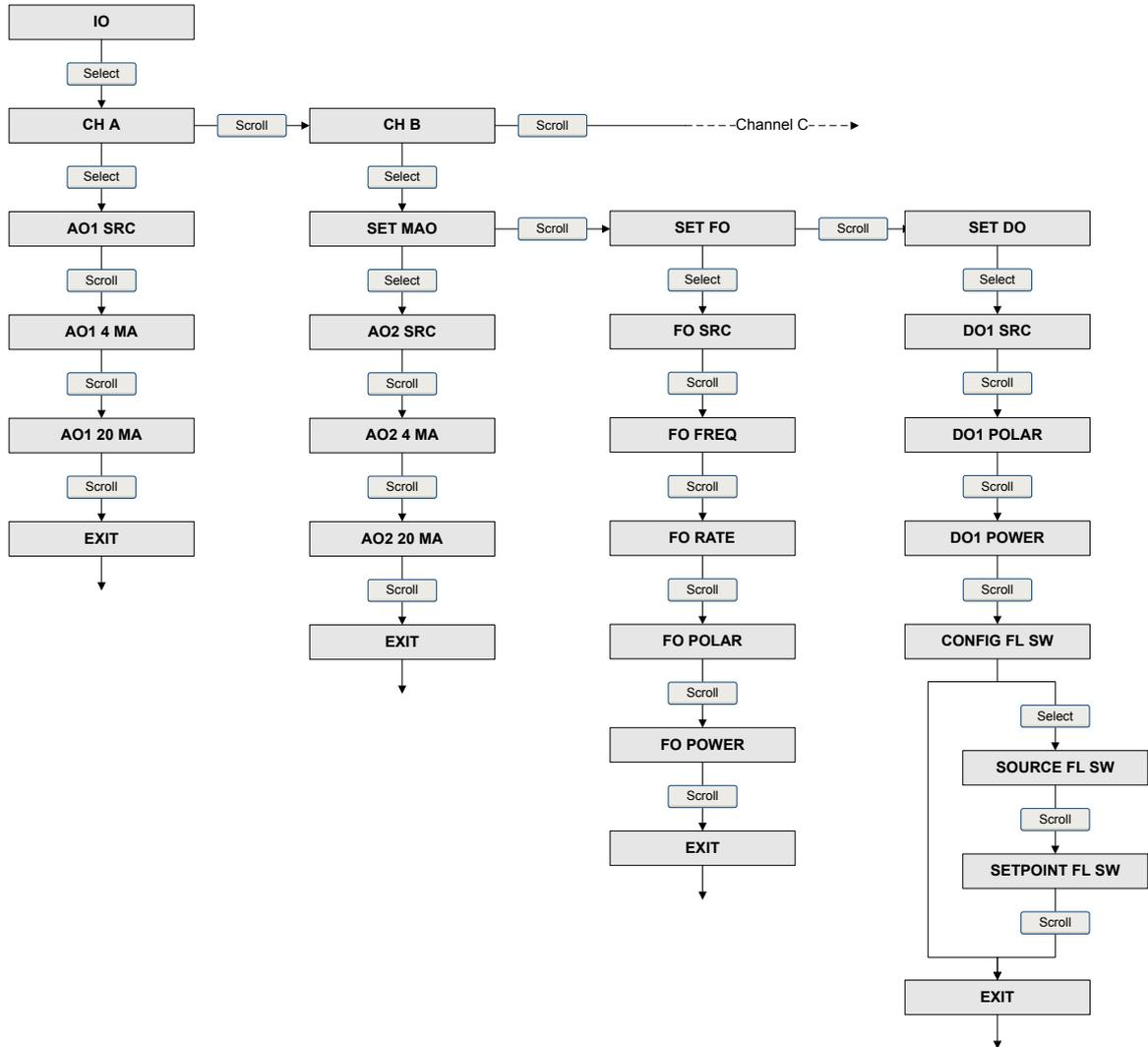
Figura A-6: Menú fuera de línea: configuración de la E/S (continuación)
