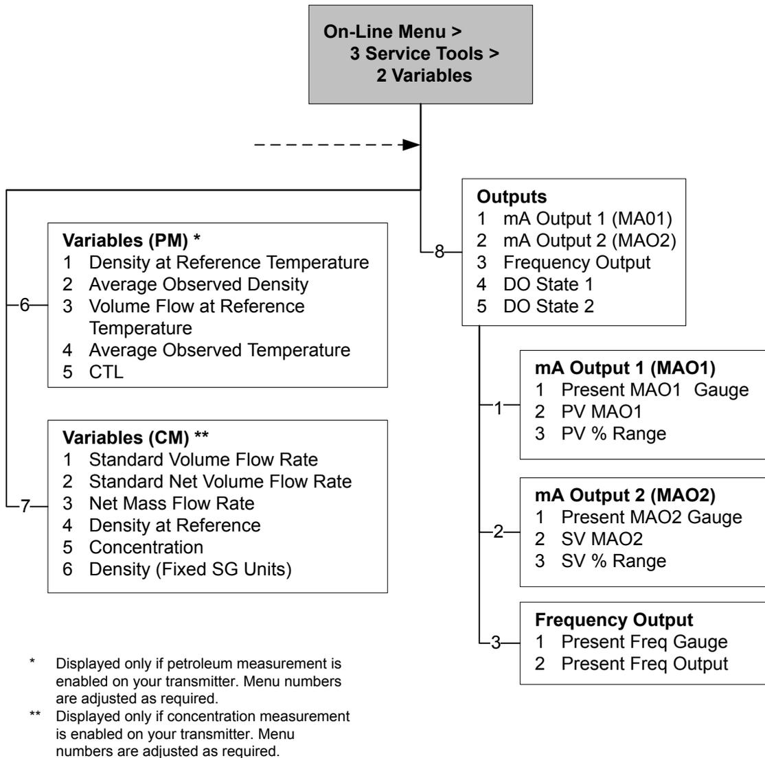
**Figura D-18: Menú Herramientas de servicio: Mantenimiento**
