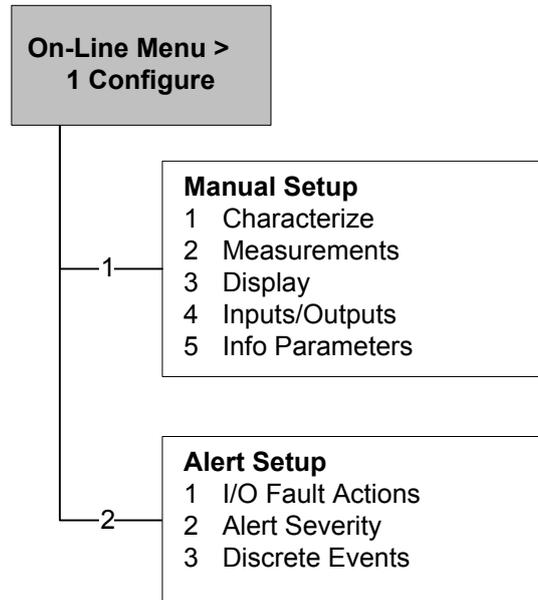
**Figura D-7: Menú Configuración manual**
