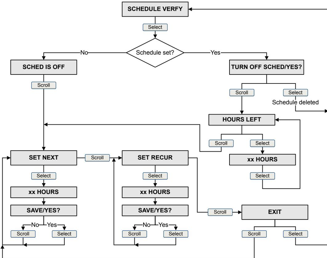
Figura A-10: Menú fuera de línea: prueba de verificación del medidor
