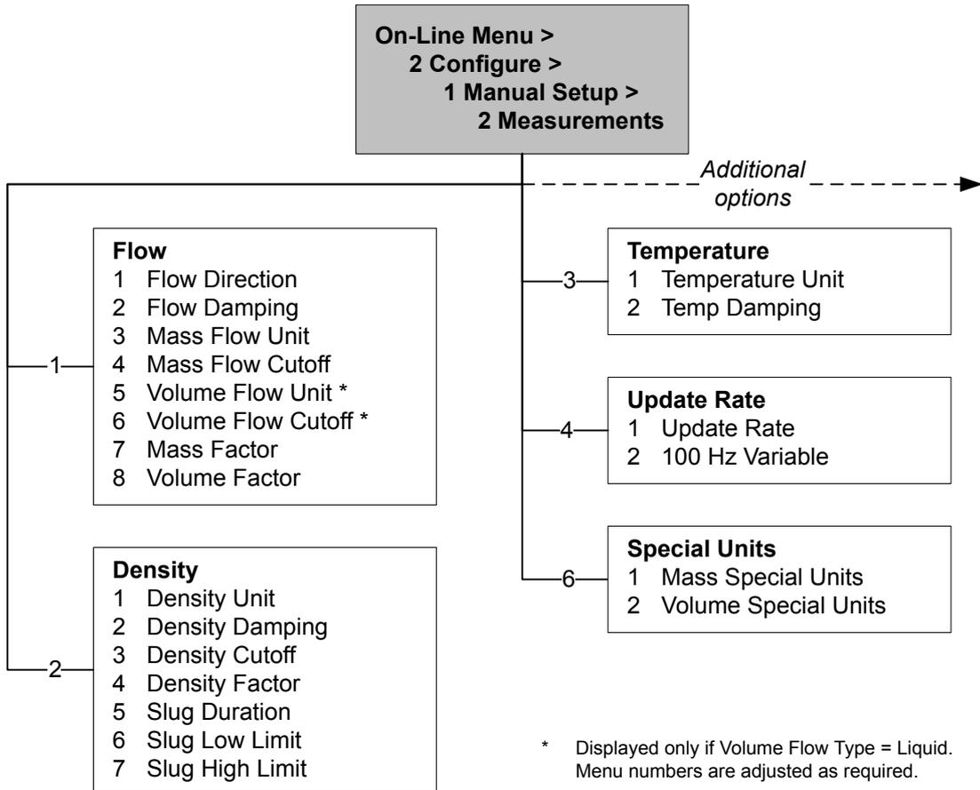
Figura D-10: Menú Configuración manual: Mediciones (continuación)
