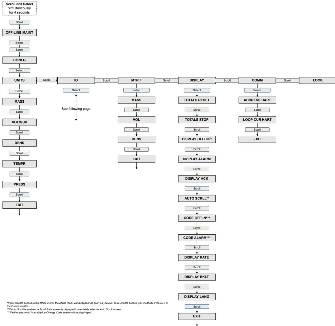
Figura A-5: Menú fuera de línea: configuración de la E/S
