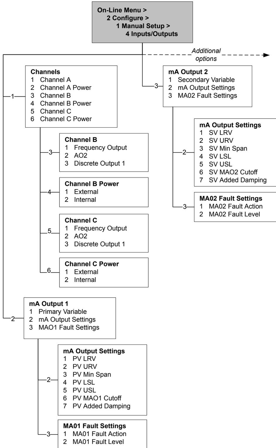
Figura D-13: Menú Configuración manual: E/S (continuación)
