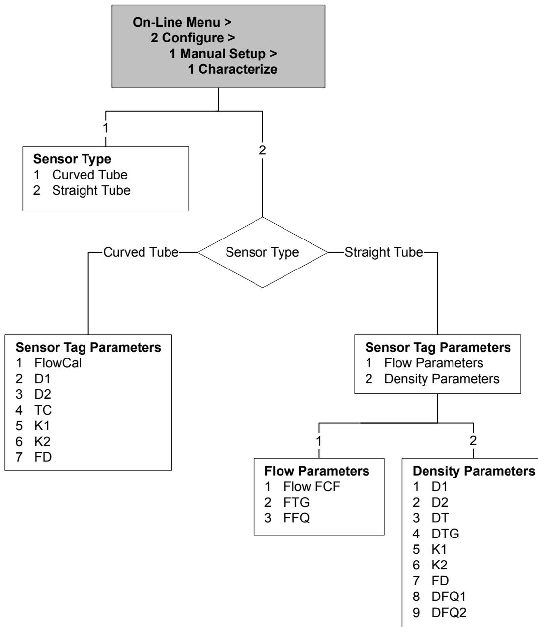
Figura D-9: Menú Configuración manual: Mediciones
