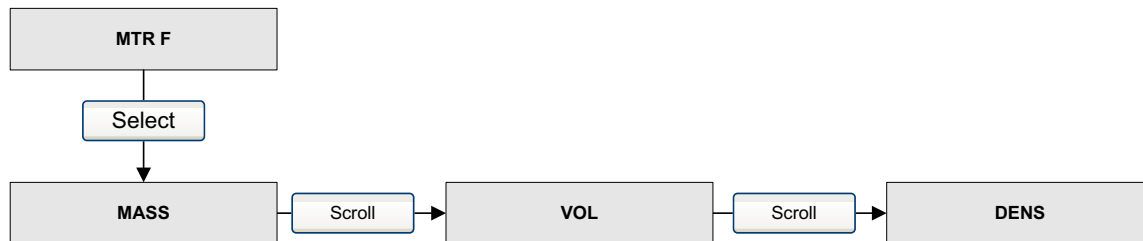
Figura B-12 Menú del indicador – mantenimiento off-line: Configuración: Factores del medidor
