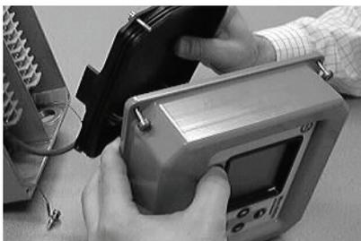
4. Drehen Sie den Bedieninterface Gehäusedeckel in die gewünschte Position.
