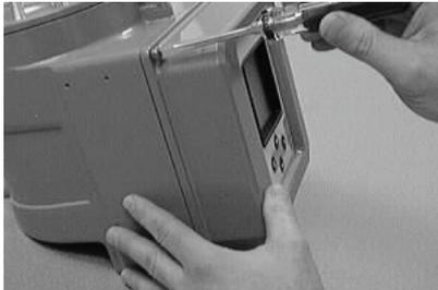
1. Lösen Sie mit einem Schlitz-Schraubendreher die unverlierbaren Schrauben, die den Bedieninterface Gehäusedeckel befestigen.
