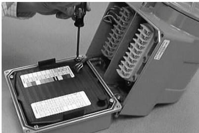
2. Lösen Sie mit einem Schlitz-Schraubendreher die unverlierbaren Schrauben, die die rückseitige Abdeckung mit dem Bedieninterface Gehäusedeckel verbinden. Achten Sie darauf, an welcher Schraube die Masse an der rückseitigen Abdeckung angeschlossen ist.
