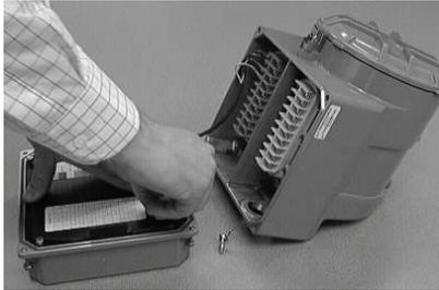
6. Ziehen Sie das Druckausgleichsventil nach oben, während Sie die rückseitige Abdeckung wieder an ihren Platz drücken. Achten Sie darauf, dass die Masse der rückseitigen Abdeckung an der richtigen Schraube angeschlossen ist. Ist die Masse an der falschen Schraube angeschlossen, kann das zu Quetschungen des Massekabels führen.
