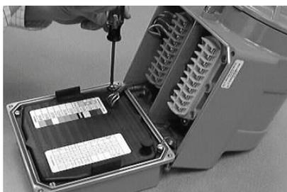
2. Dévisser les vis imperdables qui maintiennent le dos de l'indicateur en place dans le couvercle. Noter quelle vis relie le fil de masse au dos de l'indicateur.
