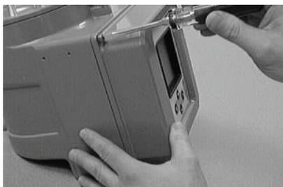
1. A l'aide d'un tournevis à tête plate, dévisser les vis imperdables qui maintiennent le couvercle de l'indicateur en place sur le boîtier.
