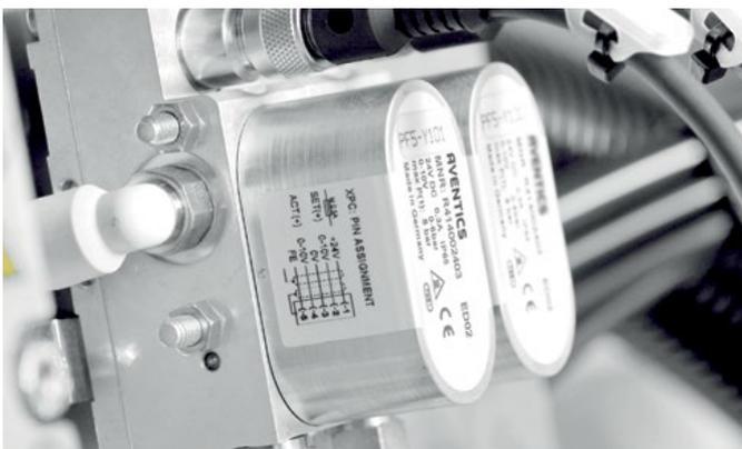
La technologie proportionnelle remplace les dispositifs de contrôle on/off qui nécessitent un encombrement plus important. ► p. 11
