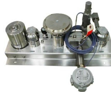
Pannello di controllo su misura per l'applicazione di erogazione carburante a idrogeno che incorpora filtrazione, valvole di controllo pneumatico, regolatore di pressione, valvola di sicurezza e trasduttore di pressione.
