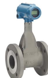
El caudalímetro vórtex para servicios auxiliares Rosemount 8600 ofrece una estructura fundida para minimizar los puntos donde puedan ocurrir fugas y está optimizado para varias aplicaciones de uso general y de vapor de servicio auxiliar.
