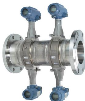
Los caudalímetros de tipo vórtex dual y cuádruple de Rosemount 8800 están bridados y cuentan con electrónica y sensores redundantes. Use estos caudalímetros con certificación SIL para SIS y otras aplicaciones en las que la redundancia sea fundamental.
