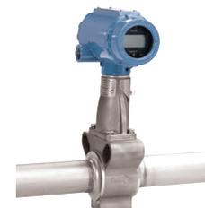
O fluxímetro Rosemount 8800 Weld-End Vortex (com extremidade soldada) é diretamente soldado na sua tubulação de processo, eliminando as juntas de flange. Este fluxímetro é o único fluxímetro Vortex disponível sem possibilidades de pontos de vazamento.
