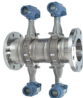
Die Rosemount 8800 Zweifach- und Vierfach-Vortex-Durchflusssysteme sind Messgeräte in Flanschbauweise mit redundanter Elektronik- und Sensorausstattung. Verwenden Sie diese SIL-zertifizierten Durchflusssysteme für SIS- und andere Anwendungen, bei denen Redundanz ein kritischer Faktor ist.
