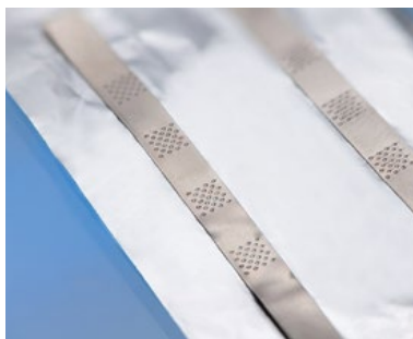
Petite batterie : languette Al + feuille Al
