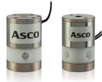
Queste valvole a separazione sono progettate per l'uso con liquidi altamente aggressivi, con un corpo in PTFE e una membrana che isola i componenti interni dell'elettrovalvola dal fluido.
