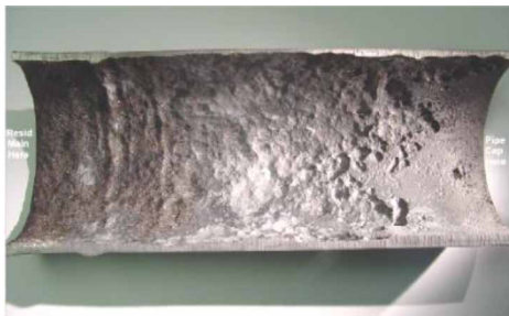
Рис. 4. Коррозия под действием нафтеновых кислот [данные предоставлены Nalco Champion]
