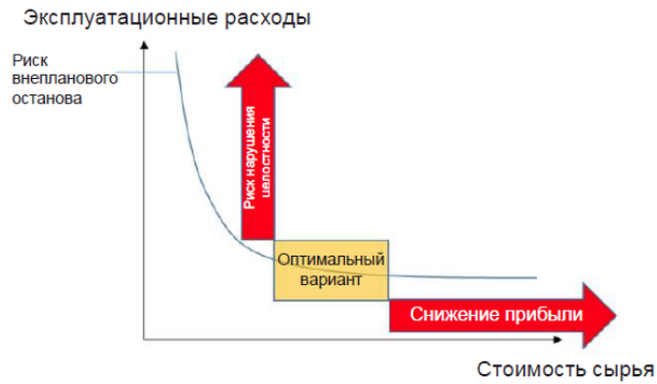
Рис. 2. Выбор баланса между ценой/качеством сырой нефти и повышенным риском возникновения проблем с целостностью установки (и сопутствующими расходами)
