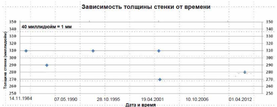
Рис. 12. Портативные ультразвуковые измерения в фиксированном месте с течением времени [предоставлено Chevron]
