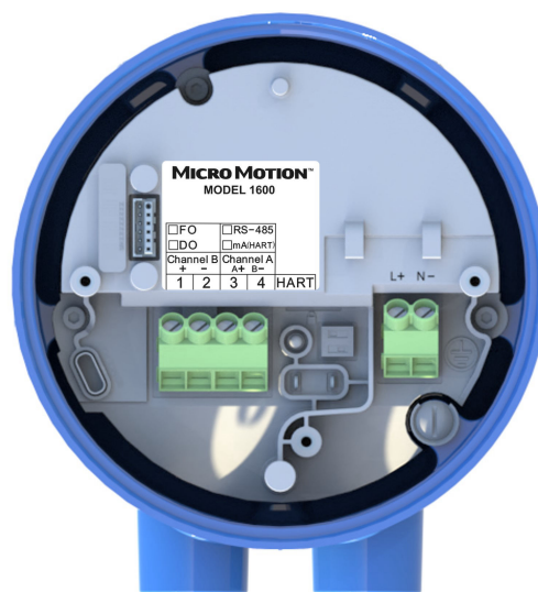
図 5-1 : 電源配線端子と機器の接地の位置
