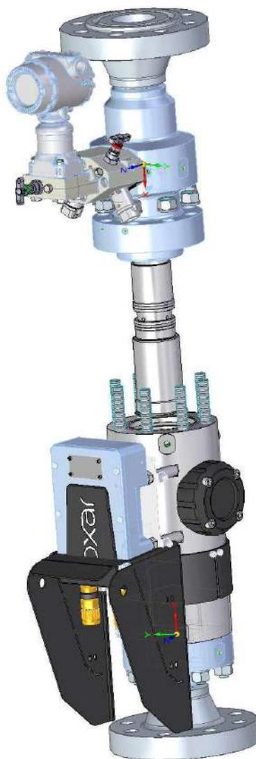
Рисунок 11. Сборка корпуса/верхнего фланца трубки Вентури на корпусе расходомера.
