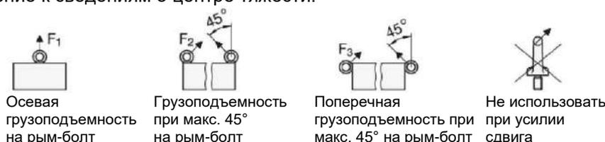
**Рисунок 1. Выдержка из инструкции по эксплуатации Ganter Griff на рым-болты DIN 580. Аналогичная инструкция по эксплуатации должна быть в наличии у всех поставщиков рым-болтов и должна соблюдаться**
