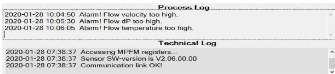
Рисунок 10. Панели технологической и технической сигнализации расположены внизу главного окна SCP
