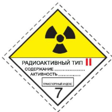
Рисунок 11. Маркировка радиоактивного источника, если мощность поверхностной дозы превышает 5 мкЗв/ч
