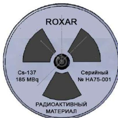
Рисунок 2. Маркировка на капсуле с источником
