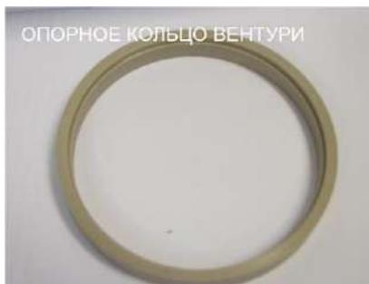
**Рисунок 5. Roxar MPFM 2600 со снятым опорным кольцом Вентури**
