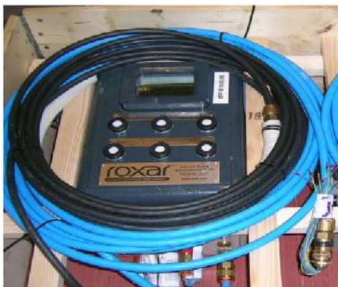
**Рисунок 2. Ящик с вычислителем расхода**
