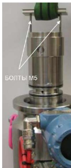
**Рисунок 6. Подъем трубки Вентури из корпуса расходомера Roxar MPFM 2600**
