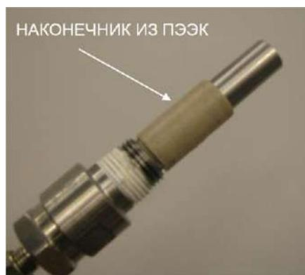
Рисунок 2. Защитная гильза с наконечником из ПЭЭК
