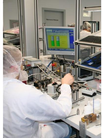
**Инженерные решения** производятся в чистой среде, эквивалентной классу 8, для минимизации загрязнений, что позволяет предотвратить переделку при производстве.
