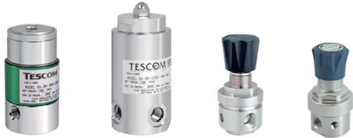
Регуляторы давления TESCOМ предназначены для подвижных составов, работающих на водородном топливе, и отличаются сверхкомпактной конструкцией и малым весом. Благодаря этим свойствам данные регуляторы являются оптимальным решением для понижения давления топлива, транспортируемого из бака для хранения в блок топливных ячеек.
