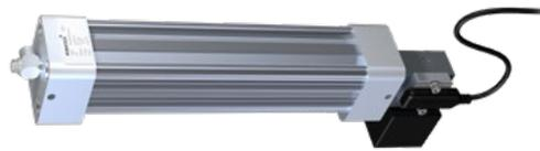
Компактный осушитель AVENTICS RDDmini — это осушитель с одной колонной для компрессорных нагрузок величиной до 60 %, который предназначен для вспомогательных систем, используемых на железнодорожном транспорте, таких как устройства подачи песка, смазки фланцев колес, управления сиденьем машиниста и подъема токосъемника.
