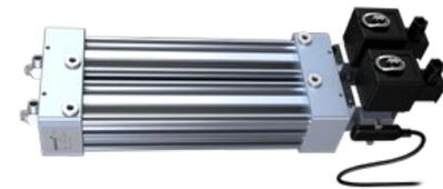
Компактный осушитель воздуха AVENTICS RDDmini Twin — это осушитель с двумя колоннами, который предназначен для вспомогательных пневматических систем, требующих непрерывной подачи воздуха, и выполняет функцию стандартного осушителя воздуха, работающего по принципу адсорбции с перепадом давления.
